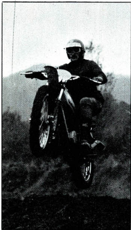
Altri momenti della nostra prova. La Scarab C risponde bene nei salti e nel controsterzo. Nelle discese bisogna spostarsi il più possibile all'indietro per evitare impuntamenti dell'avantreno causati dall'interasse contenuto.
